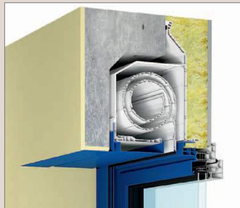
Le bloc-baie ½ linteau
